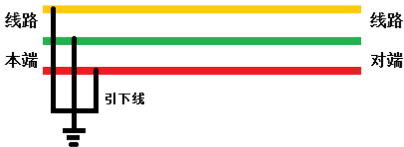
图 6-3 将被测线路本端引下线接地
